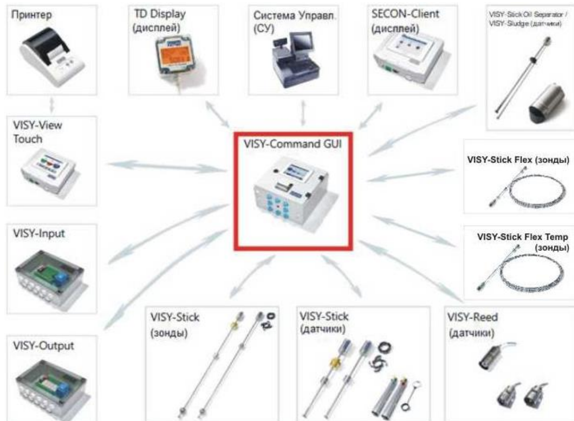
Рисунок 3.1.: Структура подключения компонентов системы к контроллеру VISY-Command
