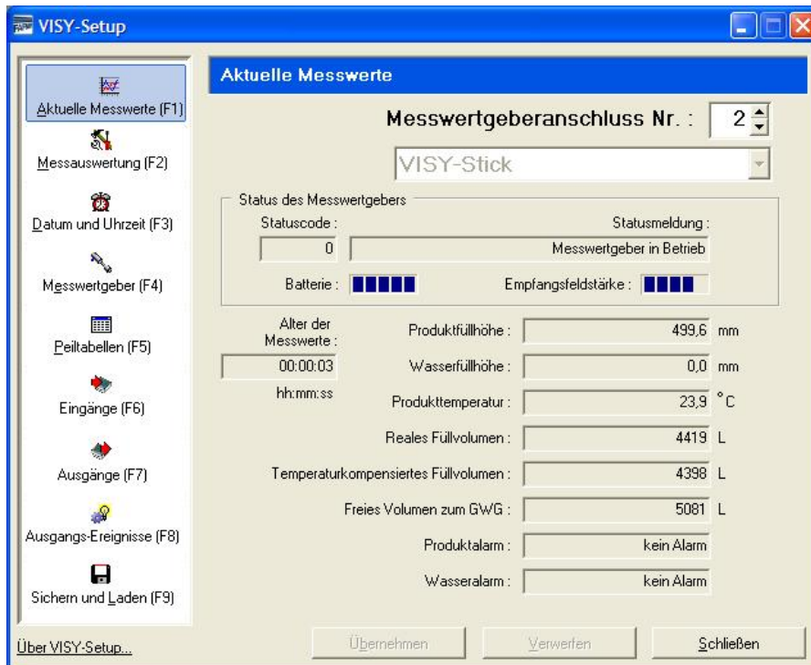
Abbildung 16: VISY-Setup Menü „Aktuelle Messwerte“ mit der Anzeige von „Alter der Messwerte“, „Empfangsfeldstärke“ und „Batterie“
