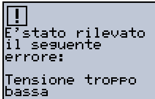
Figura 16: Visualizzazione di errore, tensione troppo bassa
