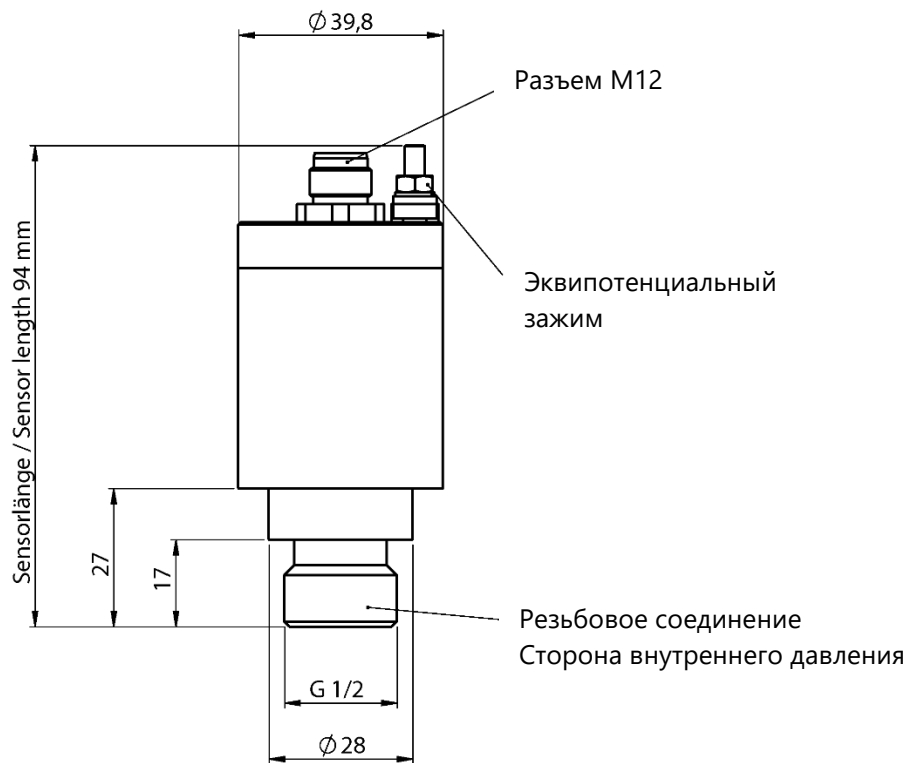
Рисунок 1: Размеры датчика давления VPS-L
